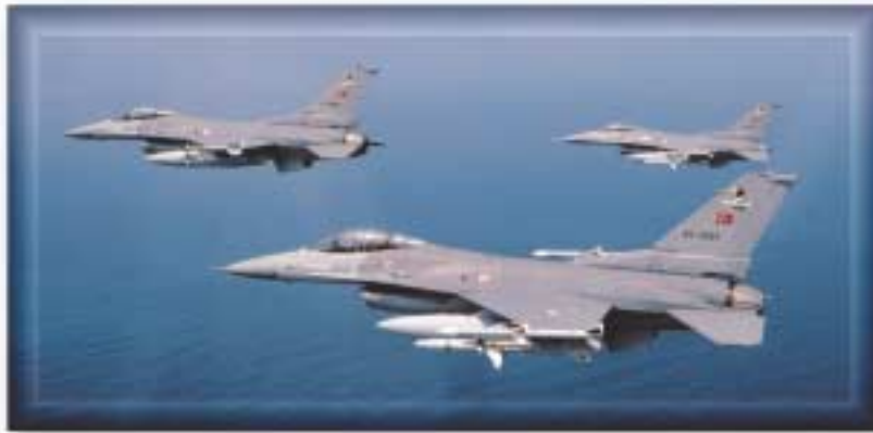
AIM-120 AMRAAM, AIM-9 Sidewinder ve AGM-88 HARM füzeleriyle silahlandırılmış 151nci Filo'ya ait F-16C Blok 50 uçakları Karadeniz üzerinde görülüyor.
