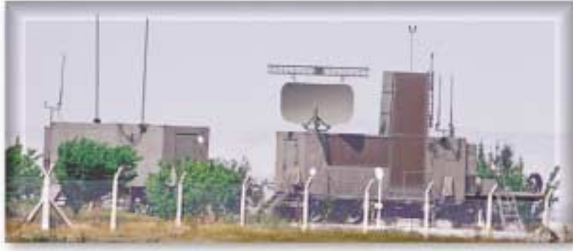
3nü Ana Jet Üs Komutanlığı'na ait AN/MPN-14K RAPCON mobil radar yaklaşma kontrol sistemi görülmekte.
