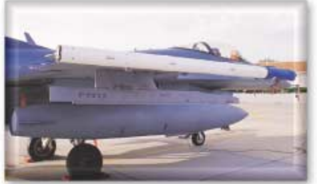
F-16C uçağının sağ kanat ucuna monte edilmiş EHUD III ACMI podu görülmekte.
