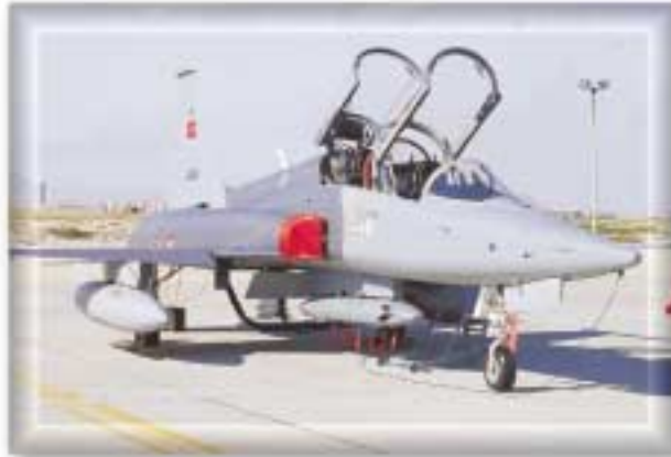
F-5 2000 modernizasyon projesi kapsamında toplam 48 uçağın gövde ve aviyonik sistemleri modernize edilmektedir.
