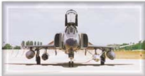
Kanat altında Popeye stand-off füzesi ve data link podu taşıyan bir F-4E 2020 Phantom uçağı görülmekte.
